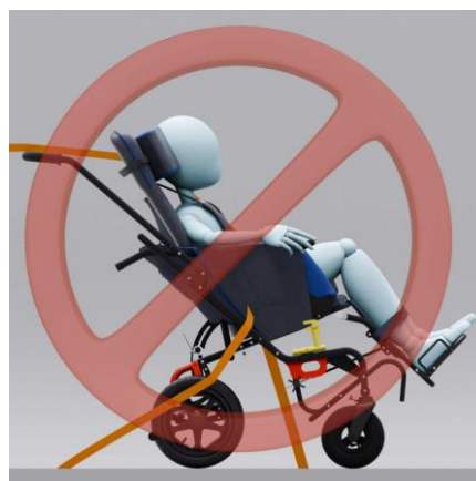
Fig. 20d Fijación incorrecta Cinturón iliotorácico – vista lateral
